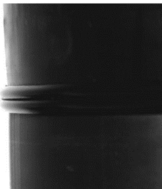
Cordón doble de reborde perfectamente alineado.
