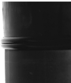
Cordón doble de reborde perfectamente alineado.
